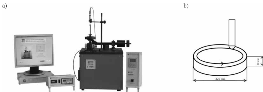
Fig. 2. View of: a) T-01M, b) pin on disc Rys. 2. Tester T-01M: a) widok ogólny, b) węzła tarcia
