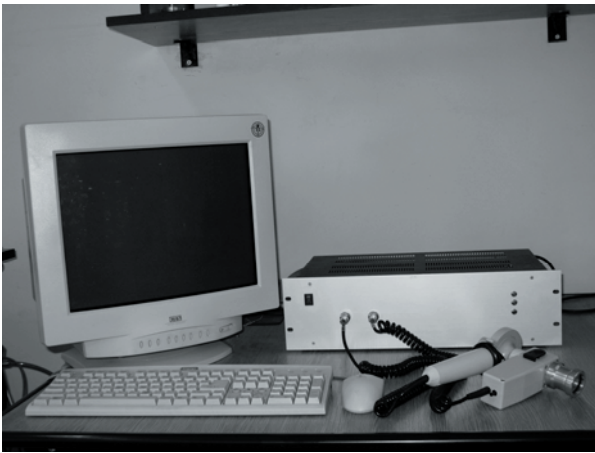
Rys. 1. Stanowisko akwizycji danych przerywanych do oceny mechaniki oddychania
