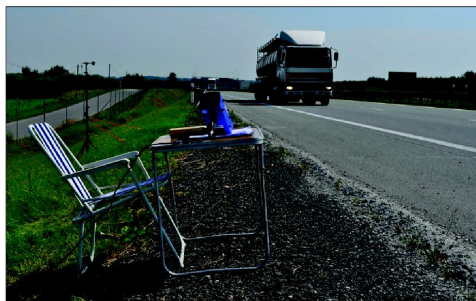
Fot. 1. Widok stanowiska do pomiaru maksymalnego poziomu dźwięku od pojedynczych pojazdów i do pomiaru równoważnego poziomu dźwięku (droga S8 – km 401+400)
