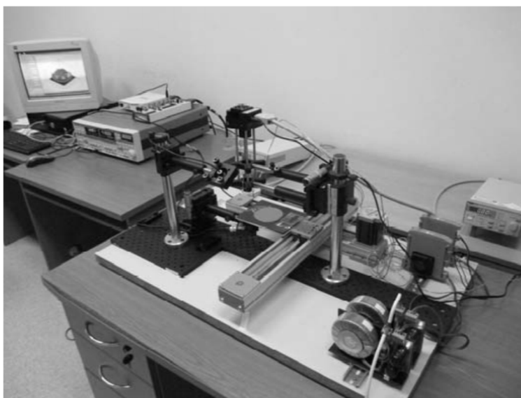
Rys. 5. Stanowisko do badań rozkładu modulowanej absorpcji na nośnikach swobodnych MFCA oraz LBIC
