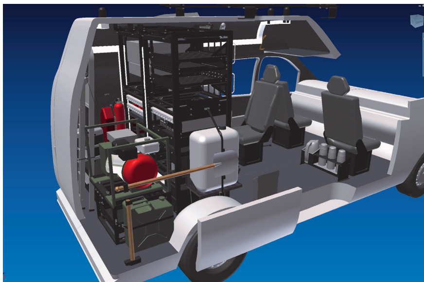
Rys. 7. Studium rozmieszczenia wyposażenia i obsługi MLB w pojeździe
