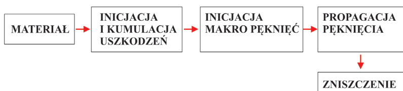
Rys. 1. Schemat procesu uszkodzenia materiału
