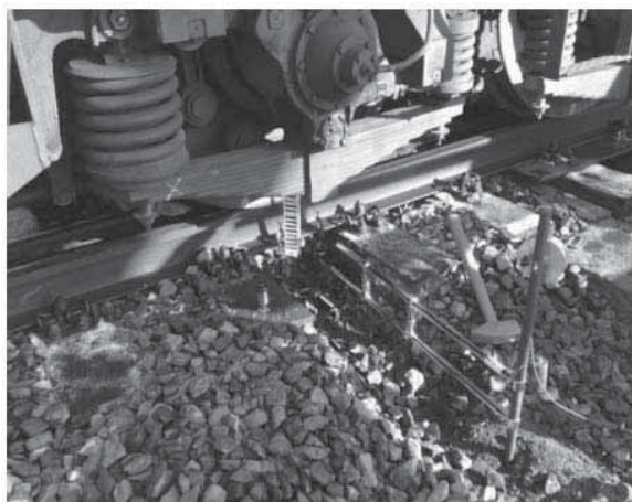
Rys. 17. Pomiary ugięć szyny od obciążeń dynamicznych na stanowisku badawczym - widok przyrządu zamocowanego do pręta wbitego do torowiska
