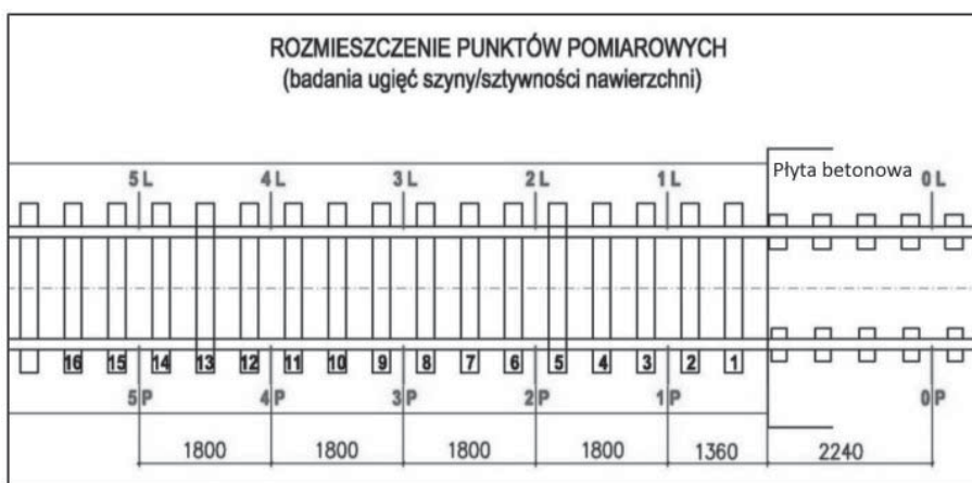
Rys. 11. Rozmieszczenie punktów pomiarowych do badania ugięć szyny (stanowisko Ruszcza)
