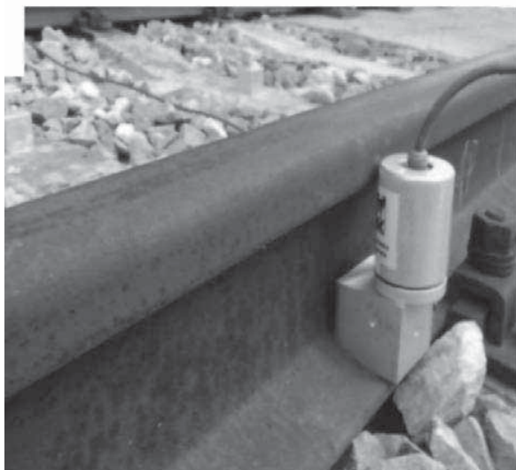
Rys. 18. Pomiar przyspieszeń pionowych szyny i podkładów
