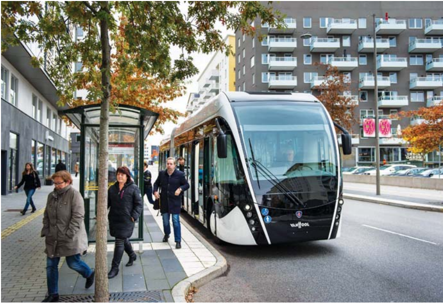
Cztery pary drzwi w autobusie Scania Van Hool Exqui.City zapewniają szybką wymianę pasażerów na przystankach
