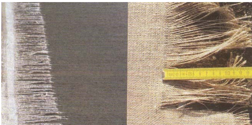
Fot. 10. Teksturowanie nawierzchni betonowej poprzez przeciąganie tkaniny z juty w kierunku podłużnym oraz wykonanie strzępienia (frędzli) na końcu tkaniny
