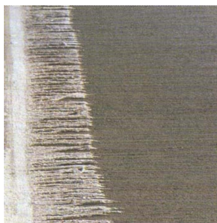
Fot. 2. Teksturuwanie podłużne z użyciem maty jutowej
