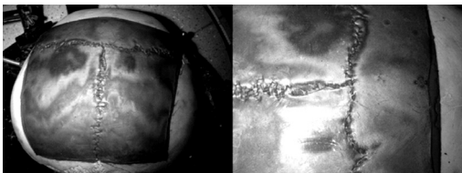
Rys. 10. Model SLS sklepienia czaszki z naklejoną powłoką Fig. 10. The SLS model of the cranial syndesmosis with the optically sensitive coating
