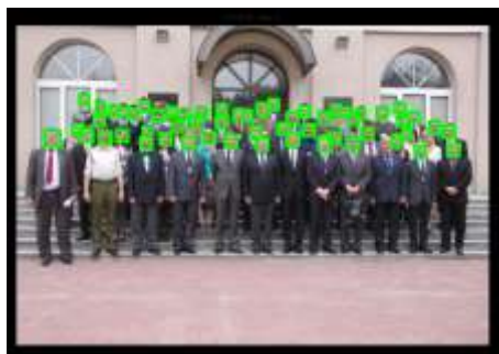
Rys. 5. Prezentacja działania zastosowanego kaskadowego klasyfikatora cech typu Haara [źródło oryginału zdjęcia-archiwum własne]
