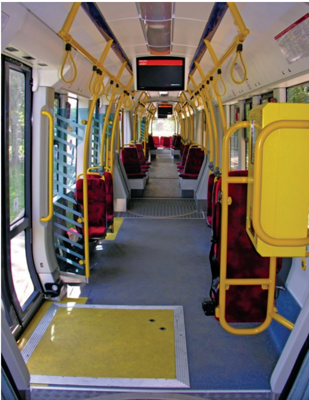
Fot. 8. Wnętrze niskopodłogowego tramwaju Swing 120Na Tramwajów Warszawskich zostało zoptymalizowane pod kątem wymagań osób niepełnosprawnych
