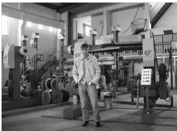
Fot.1. Instalacja do radiacyjnego sieciowania kabli i przewodów elektrycznych
