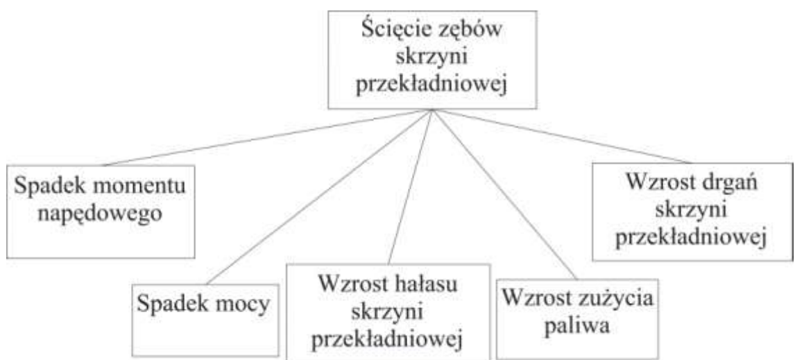
Rys.6. Symptomy diagnostyczne ścięcia zębów skrzyni przekładniowej
