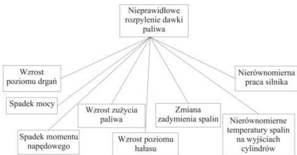
Rys.11. Symptomy diagnostyczne nieprawidłowego rozpylenia dawki paliwa
