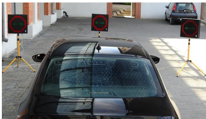
Rys. 1. Stanowisko do badań czasów reakcji złożonej – widok ogólny
