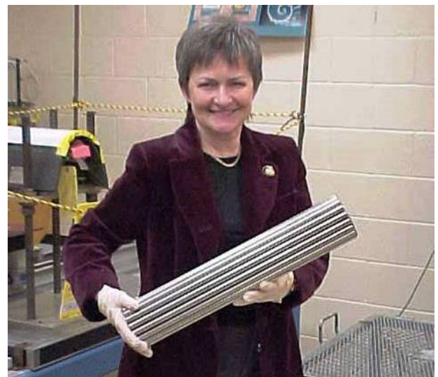
Fot. 3. Wiązka paliwowa reaktora typu CANDU Photo 3. CANDU Fuel Bundle
