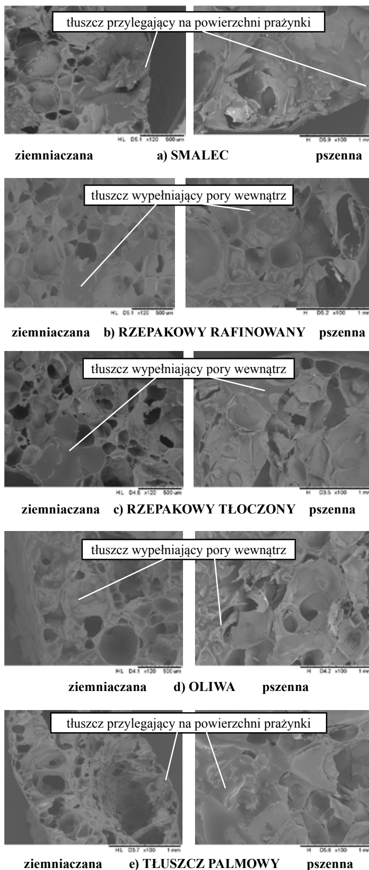
Rys. 6 a, b, c, d, e. Mikrostruktura smażonych prażynek ziemniaczanych i pszennych smażonych w różnych tłuszczach. Fig. 6 a, b, c, d, e. The microstructure of fried potato and wheat snacks in different fats.
