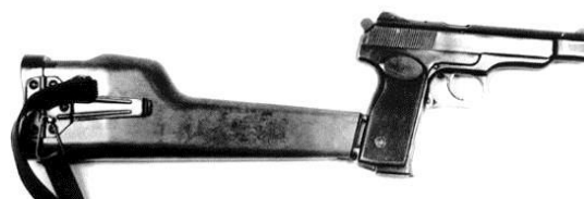
Fot. 2. 9 mm pistolet maszynowy Stieczkina, APS (fot. guns.ru)
