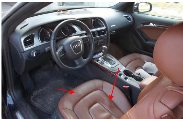
Rys. 2. Uszkodzenie fotela kierowcy.
