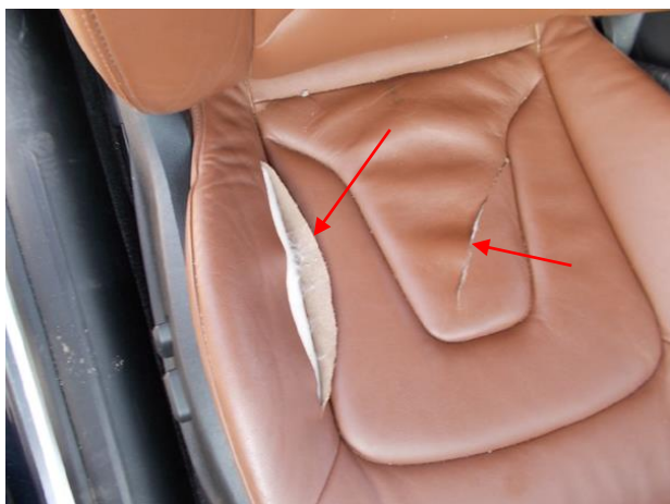
Rys. 3. Uszkodzenie siedziska fotela pasażera.
