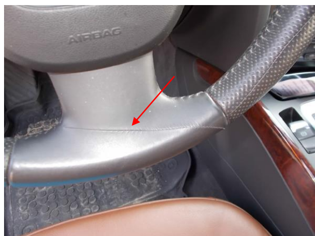
Rys. 6. Uszkodzenie koła kierownicy.
