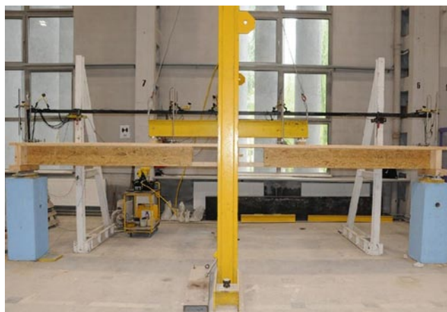
Rys. 3. Widok hybrydowej belki stropowej (HBS) na stanowisku badań doraźnych
