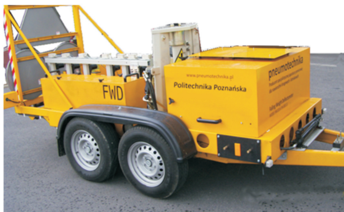
Fot. 1. Widok polskiej przyczepy FWD zbudowanej w ramach konsorcjum (model ASTEC-120-2013-9G)
