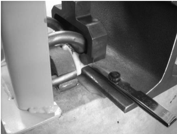
Rys. 6. Sposób pomiaru w torze siły docisku łapki sprężystej
