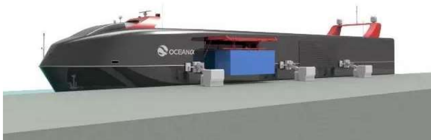
Rysunek 8. Projekt małego bezzałogowego statku Cloudborne
