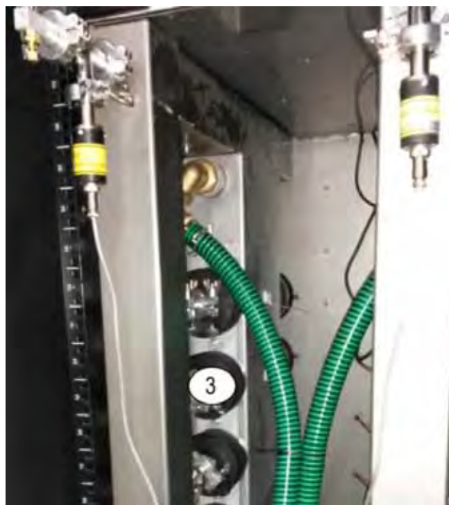
Rys. 6. Moduły plazmy oraz wielopoziomowa konstrukcja reaktora niskotemperaturowej plazmy.
