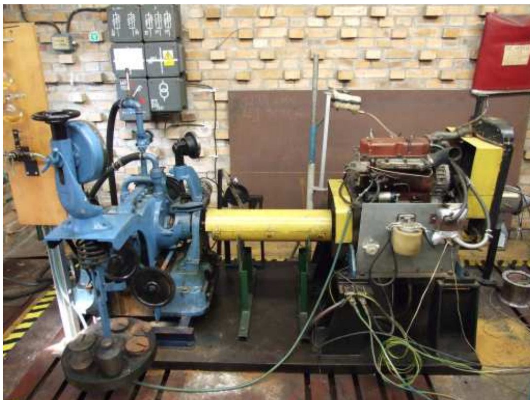
Fot. 1. Stanowisko do badań wyposażone w silnik o zapłonie samoczynnym Źródło: [5]
