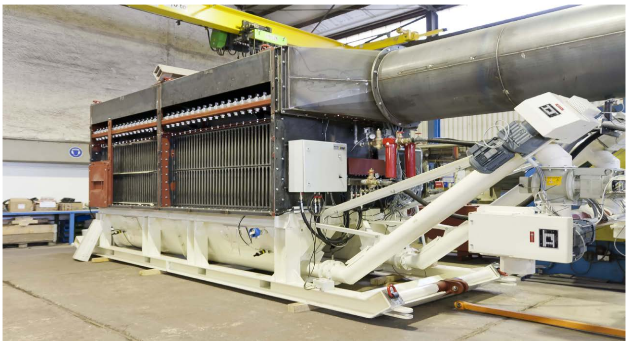
Ryc. 4. Jednostka odpylacza ze zbiornikiem i przenośnikiem ślimakowym w zakładzie CFT.
