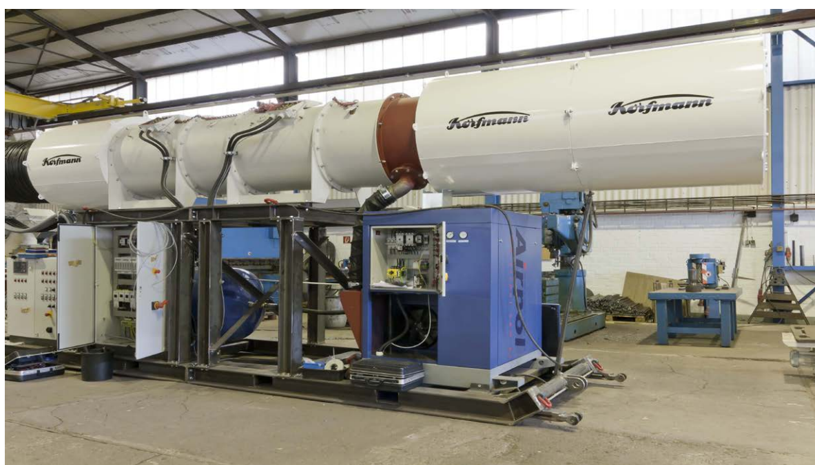
Ryc. 5. Stacja wentylatorów i sprężarek w zakładzie CFT.
