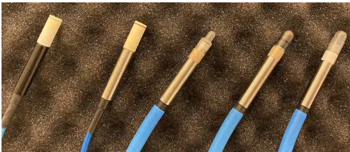
Ryc. 1 Detektory wybrane do dokonania pomiarów (od lewej): microDiamond, Dioda E, PinPoint 3D, SemiFlex 0,125 cm 3 , SemiFlex 3D
