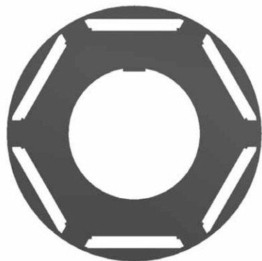
Rys. 3. Widok blachy wirnika modelowego elektrowibratora
