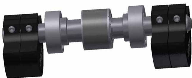
Rys. 2. Widok wirnika modelowego elektrowibratora typu SMwsk112S6
