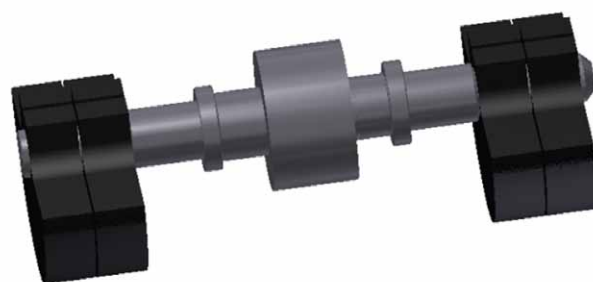
Rys. 11. Model do analizy modalnej wirnika przy konfiguracji mas dla największej siły wymuszającej elektrowibratora
