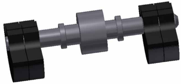
Rys. 7. Uproszczony model do analizy wytrzymałościowej wirnika modelowego elektrowibratora typu SMwsk112S6
