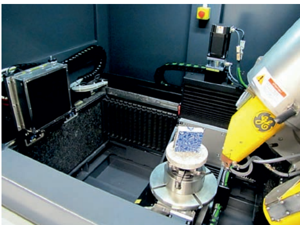
Rys. 2. Znormalizowana próbka betonu o wymiarach 10x10 cm podczas badania.
