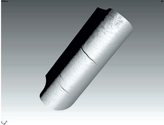
Rys. 5. Pęknięcia na krawędzi natarcia łopatki turbinowej uwidocznione podczas badania CT.
