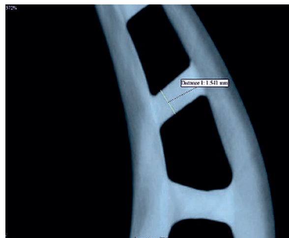
Rys. 4. Obraz geometrii wewnętrznych kanałów chłodzących łopatki turbinowej.
