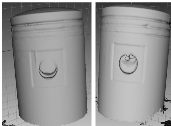
Rys. 7. Jakość modeli tłoka bez nałożonej tekstury: z lewej – rezultat skanowania skanerem Spider, z prawej – rezultat skanowania skanerem Eva [opracowanie własne]
