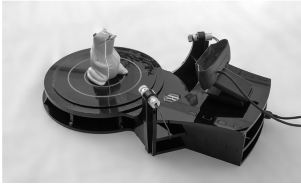
Rys. 2. Skanowanie 3D metodą bezdotykową [5]
