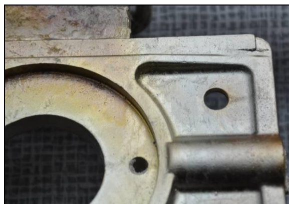
Rys. 8. Przykładowy stan powierzchni zewnętrznej odlewu precyzyjnego, ze stopu miedzi typu BA1044, uzyskany na stanowisku prototypowym do kierunkowego krzepnięcia chłodzonego w cieczy polimerowej [11]
