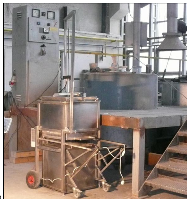
Rys. 6. Ogólny widok do badania procesów kierunkowego, szybkiego krzepnięcia odlewów aluminiowych w formach ceramicznych [6]: a) od strony układu sterowania i b) strony przeciwnej
