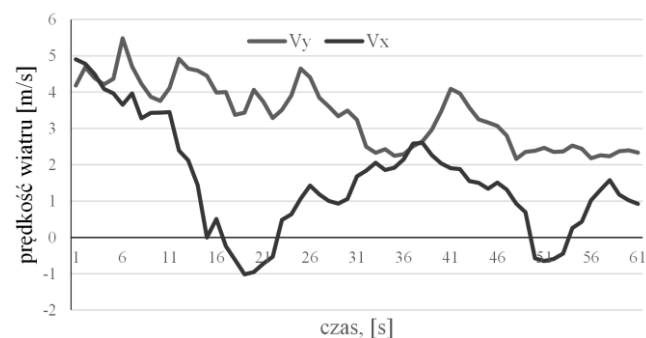
Rys. 4. Jednominutowy zapis składowych prędkości wiatru Fig. 4. One-minute measurements of wind speed components
