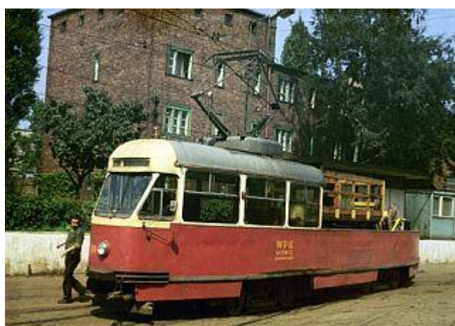
Rys. 12. Wagon roboczy 61R – „Wanienka” [11]
