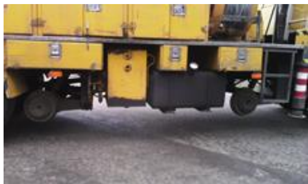
Rys. 4. Specjalne rolki do poruszania się po szynach
