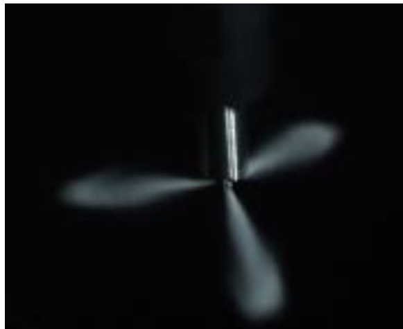
Rys. 5. Struga wtryskiwanego paliwa we wtryskiwaczu fabrycznym
