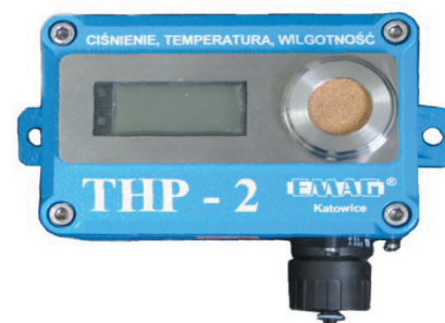
Fig. 3. THP-2 air physical parameter sensor
