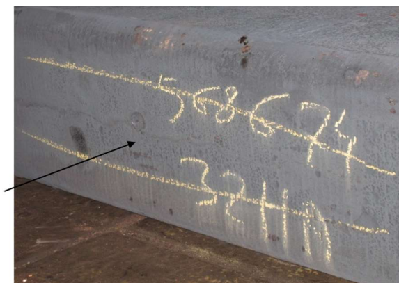
Fig. 1 Longitudinal crack ingot
