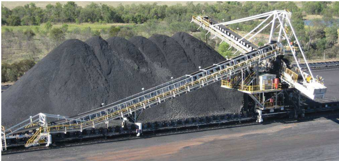
Rys. 3. Budowanie stosu przez układarkę [3]
