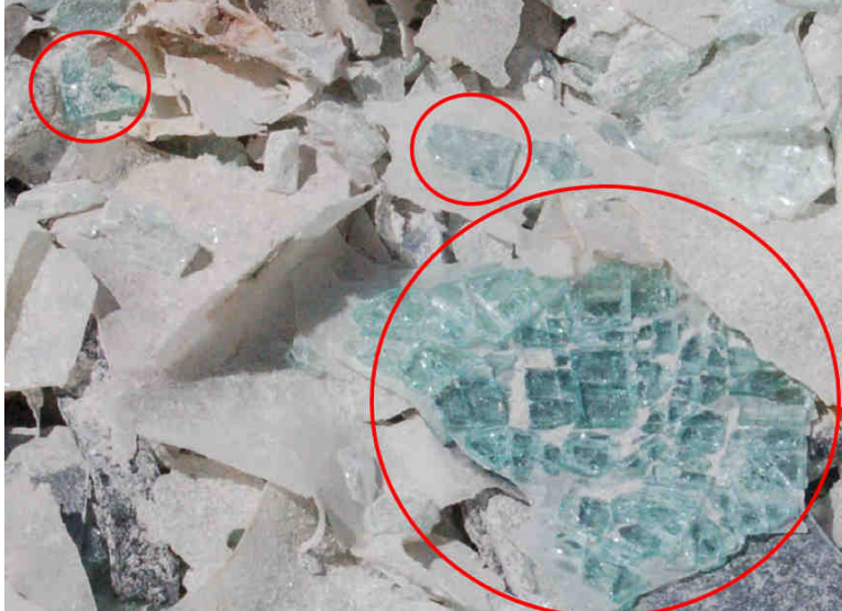
Rys. 6. Przykładowa folia odpadowa PVB ze szkłem resztkowym
