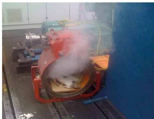
Rys. 5. Widok ogniw Li-poly oraz LiFePO4 po zakończonej próbie przeładowania [1, 2, 3]
