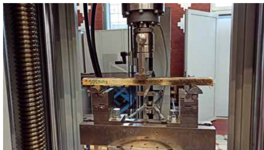
Fot. 1. Stanowisko badawcze: a) dla ściskania w poprzek włókien, b) dla ściskania wzdłuż włókien, c) dla zginania; źródło: opracowanie własne
