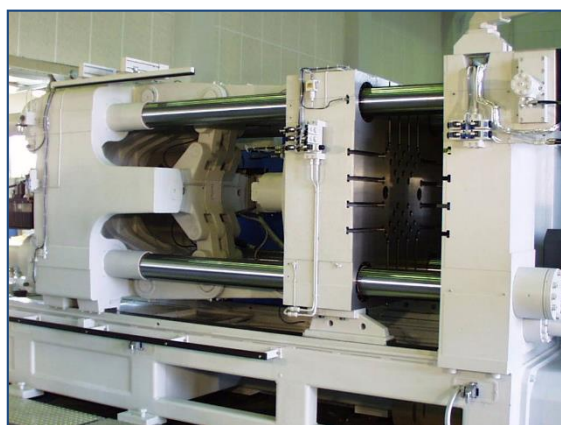
Rys. 5. Dźwigniowo-przegubowy układ zwierania w maszynie typu DAK-M firmy FRECH z klasycznym układem 3 płyt
