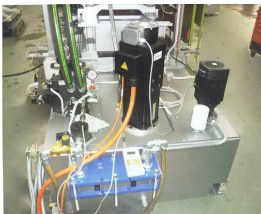
Rys. 4. Praktyczne zastosowanie pomp Sytronix – SvP7000 produkcji Bosch Rexroth w maszynie gorąco-komorowej firmy AGRATI
