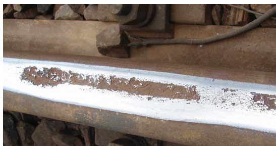
Rys. 6. Wada typu squat na powierzchni szyny
