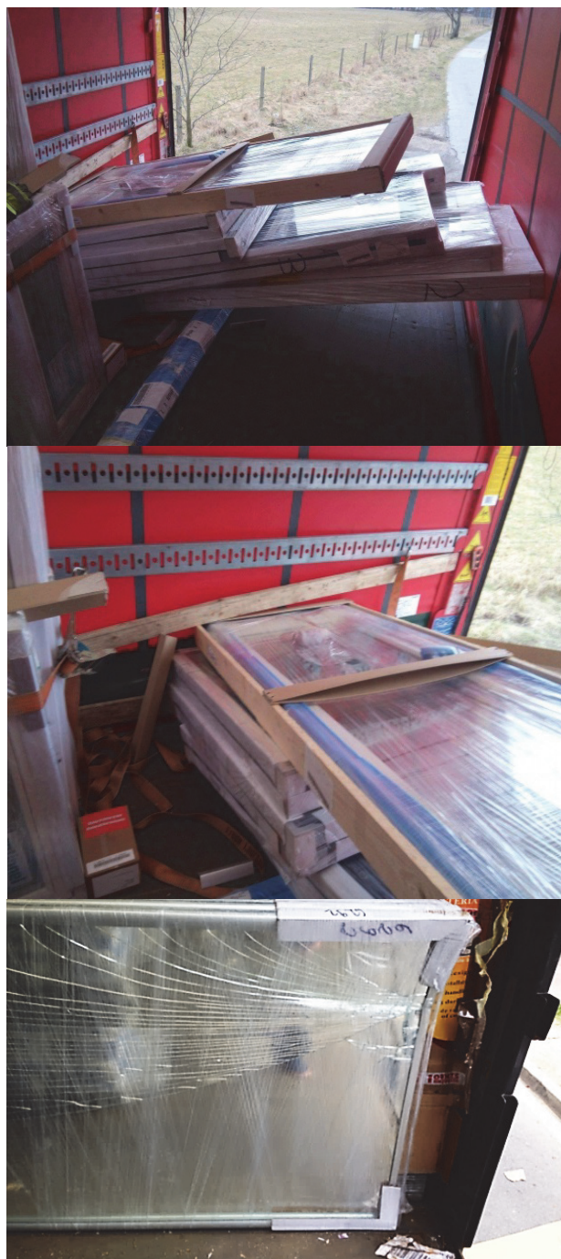
Rys. 4. Uszkodzenia przewożonych okien
