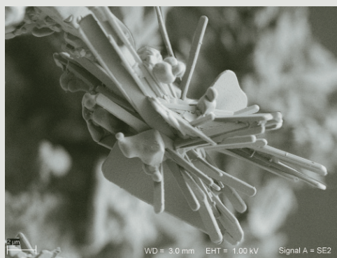
Fot. 5. Morfologia kryształów wollastonitu uzyskanego w temperaturze 1100°C z kredy jeziornej i łupka kwarcytowego.
