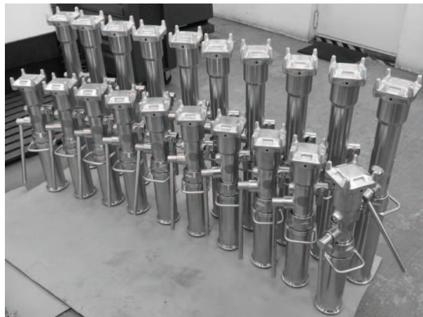
Rys. 11. Stojaki hydrauliczne obudowy HOR-01 [Źródło: opracowanie własne KOMAG]
