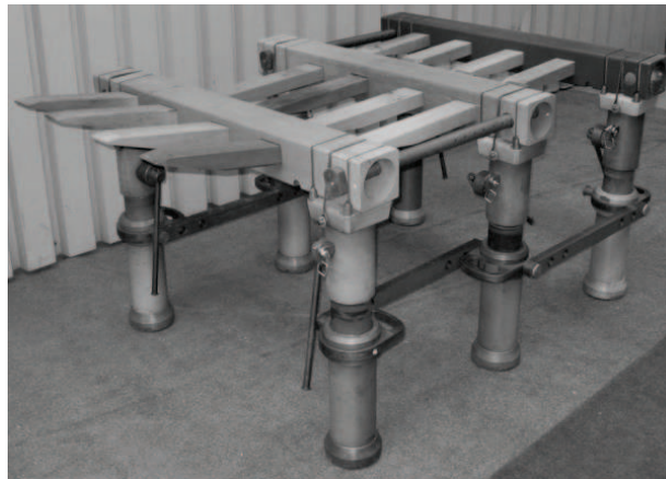
Rys. 3. Odrzwia obudowy chodnika ratowniczego K-400 [1]
