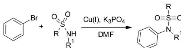
Rys. 15. N-arylosulfonamidowanie w obecności Cu (I)
