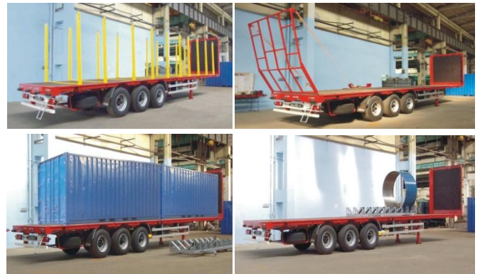
Rys.7. Warianty zabudowy naczepy uniwersalnej firmy Mega [25]
