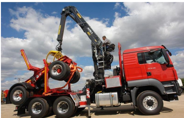
Rys. 6. Zestaw do transportu długich kłód drewnianych bez ładunku [22]
