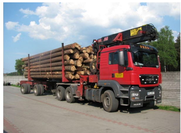
Rys. 8. Przykład zabezpieczenia drewna podczas transportu za pomocą odciągów odgórnych [24]
