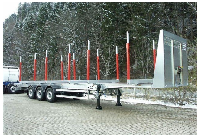
Rys.4. Naczepa kłonicowa wykonana z aluminium [15]
