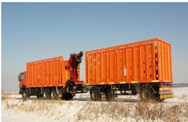
Rys. 3. Zestaw do transportu drewna krótkiego ułożonego poprzecznie [26]
