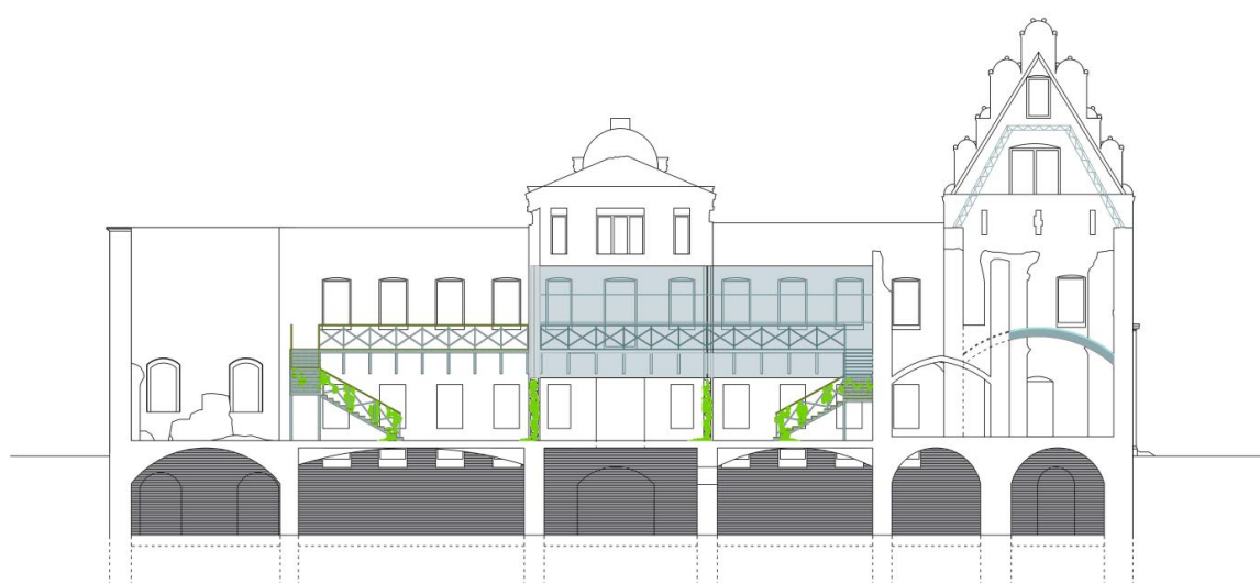
Rys. 3. Widok galerii, tymczasowego zadaszzenia oraz piwnic pałacowych
