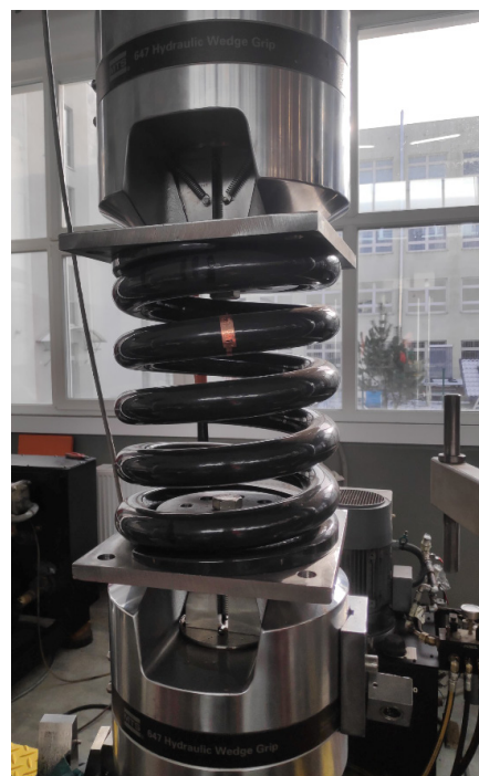
Rys. 4. Próba ściskania: a) widok maszyny, b) widok uchwytów [opracowanie własne]
