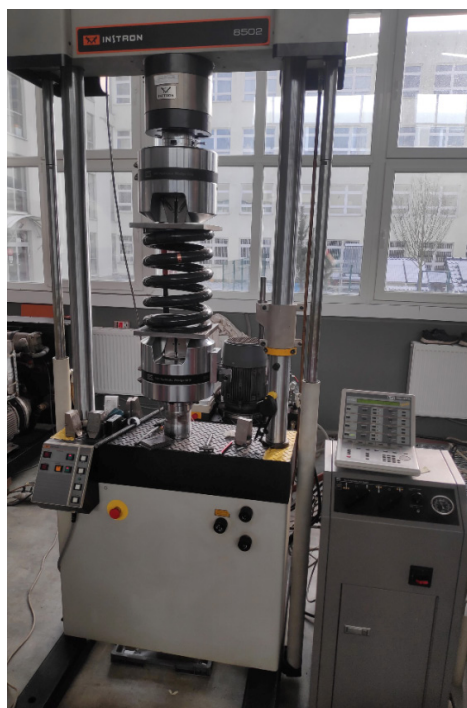
Rys. 4. Próba ściskania: a) widok maszyny, b) widok uchwytów [opracowanie własne]
