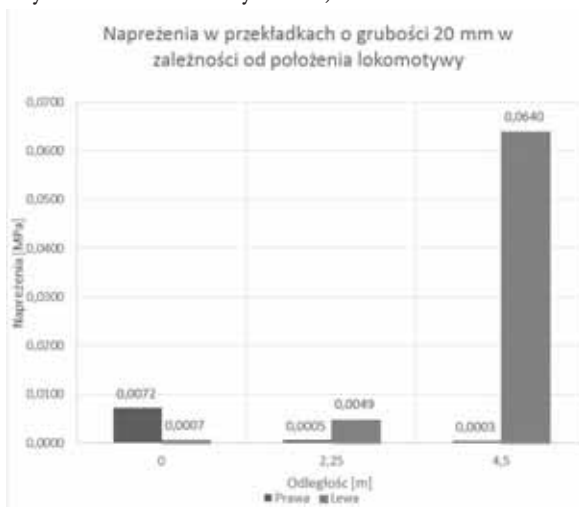
Rys. 8. Naprężenia w połączeniach elastycznych o grubości 20 mm w zależności od położenia lokomotywy.
